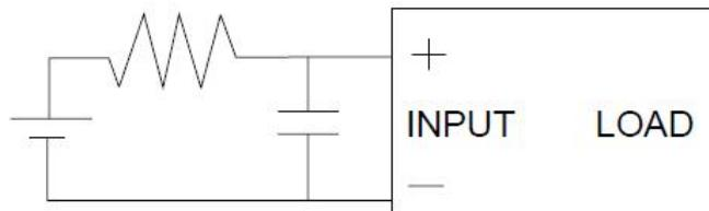
d) 推荐的使用电路，输出端的尖峰电压可能会引起 SSR 误动作，所以请在输出端应加 R/C 回路或压敏电阻吸收尖峰电压，具体见下图：
